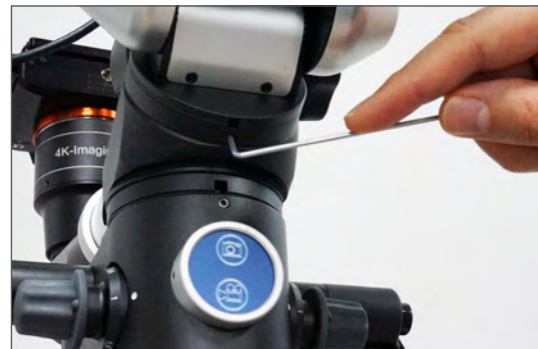
3. Sestavte binokulární a sklopný tubus k ergonomické optice (imbusový klíč 2 mm).
