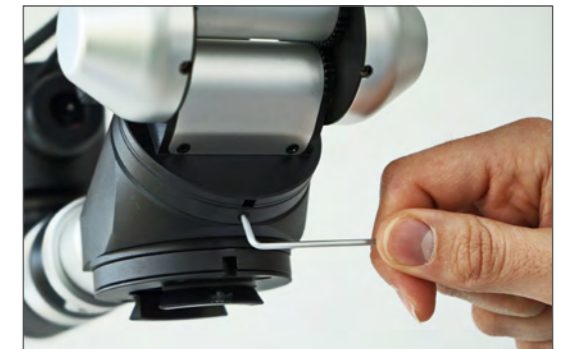
4. Sestavte binokulární a sklopný tubus k ergonomické optice (imbusový klíč 2 mm).
