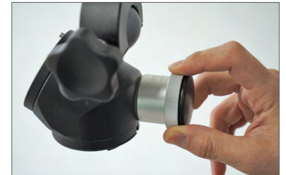
2. Sejměte kryt proti prachu z optického konektoru.
