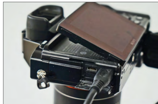
4. Připojte kabel HDMI k fotoaparátu (věnujte pozornost varování).
