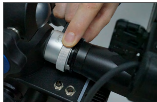
5. Vložte adaptér do optického konektoru a uložte jej kroužkem.
