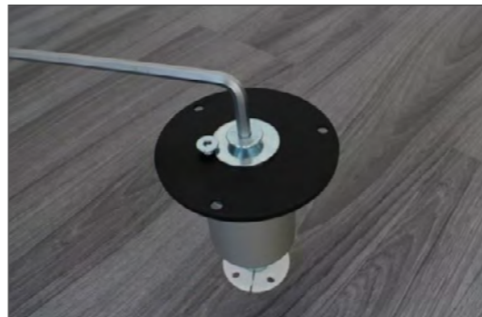
4. Součásti smontovány (dbejte na zapuštěnou polohu).
