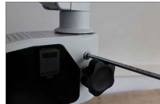
1. Povolte šroub šestihranného imbusového klíče. Potřebný klíč je přiložen.
