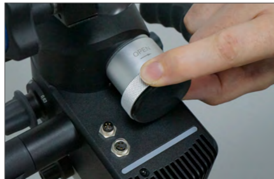
4. Sejměte kryt proti prachu z optického konektoru.
