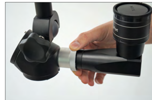
3. Vložte adaptér do optického konektoru a zajistěte jej kroužkem.
