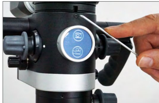
2. Namontujte osvětlovací jednotku k ergonomické optice. (2mm imbusový klíč).
