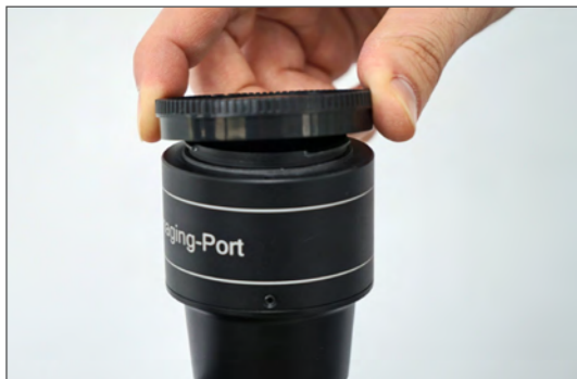
1. Sejměte z adaptéru kryt proti prachu a nasadte kameru.
