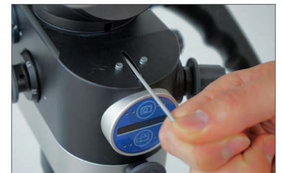
6. Namontujte osvětlovací jednotku k ergonomické optice (imbusový klíč 2 mm).
