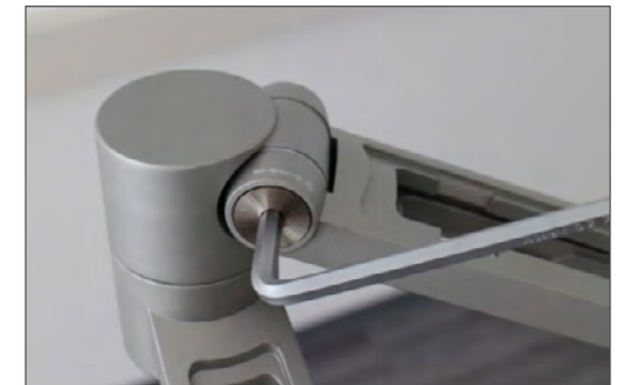
12. V případě potřeby upravte rameno monitoru podle hmotnosti monitoru.
