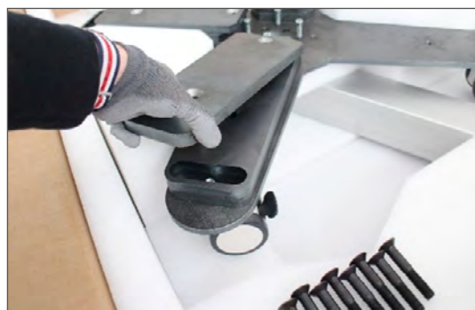
3. Odstraňte vyvažovací závaží a vytáhněte pohyblivou základnu z krabice.
