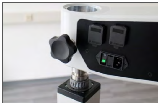
5. Připevněte závěsné rameno k vodícímu ložisku.
